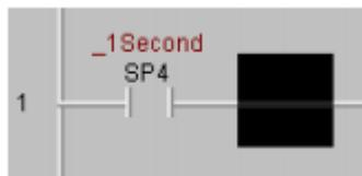
Теперь я собираюсь ввести выходную катушку coil в эту ступень. Чтобы войти в катушку, я выбираю NOP, и затем я могу нажать F7, выбрать вкладку катушки, затем выбрать катушку и нажать Enter. Но так как я знаю, что хочу выходную катушку, я могу просто переместить курсор на NOP, ввести OUT и нажать Enter. Directsoft откроет окно, позволяющее мне ввести адрес, который мне нужен для этой катушки, и затем я снова нажму ENTER.
