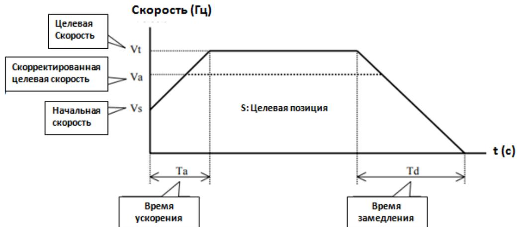
Скорректированная конечная скорость ( $V_a$ ) рассчитывается по следующей формуле:
