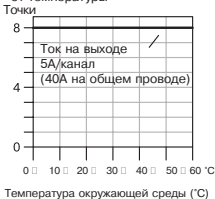
График снижения номинальных характеристик в зависимости от температуры
