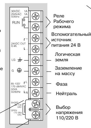
Клеммник, питание 110/220 В переменного тока
