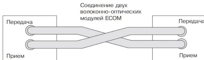
62.5/125 кабель со штыковыми разъемами типа ST
