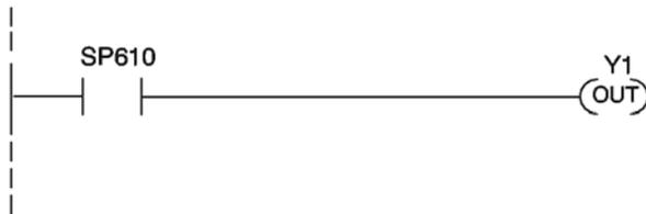
Специальное реле SP610 обнаруживает пропадание входного сигнала в канале 1. Используйте это реле для включения сигнала тревоги или для отключения внешнего устройства.
