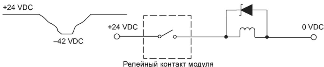
Выберите из следующей таблицы необходимый подавитель выбросов TVS или MOV в соответствии с напряжением на индуктивной нагрузке.
